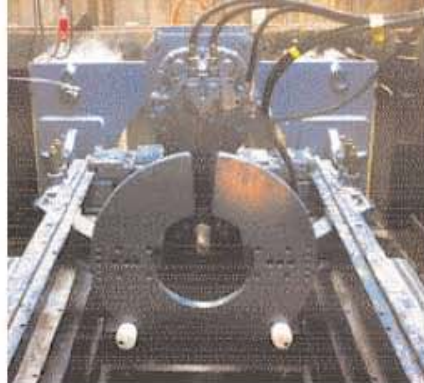
Kompaktna konstrukcija postrojenja omogućava ugradnju cevi do DN 800 i u malim jamama.
