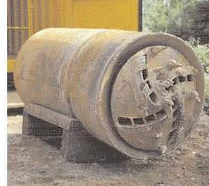
Zglob glave za bušenje zemlje omogućava promenu pravca bušenja.
